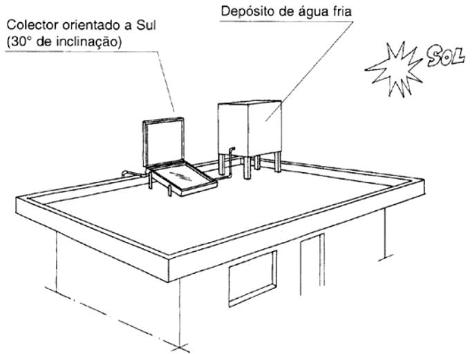
{ FIG. 5.3 } Localização do colector solar na cobertura do edificio.
