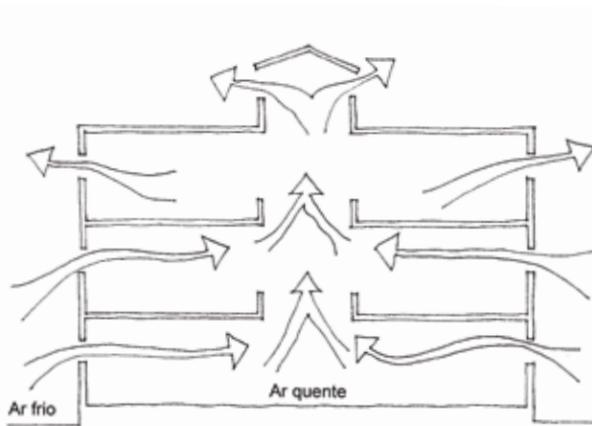
{ FIG. 3.40 } Esquema de ventilação por efeito de chaminé num edifício de átrio.
