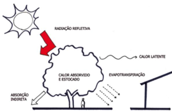
{ FIG. A3.3 } Processos de sombreamento (proteção da radiação solar) e evapotranspiração.
