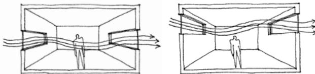
**{ FIG. 3.37 }** Posição de aberturas para dois tipos de arrefecimento. A situação do primeiro esquema é ideal para o conforto do ocupante (arrefecimento) – a entrada de ar mais fresco é feita a nível inferior. A situação do segundo esquema serve para o para arrefecimento do edifício – escoamento do ar aquecido, que sobe e se acumula junto ao tecto, é feito a nível superior. O uso de janelas altas, verticais, é ideal para permitir e controlar estes dois níveis de ventilação.
