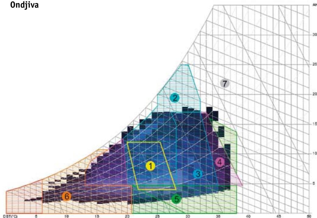
{ FIG. 3.57 } Diagramas psicrométricos – Cidades de Luanda, Uíge, Huambo, e Ondjiva. A mancha azul escura ilustra o perfil climático da região. O gráfico mostra como a zona convencional de conforto de verão da ASHRAE (1) pode ser ampliada através da utilização de várias técnicas de arrefecimento passivo. As várias zonas apresentadas nos gráficos foram definidas por Givoni (1969) e correspondem a:
