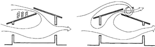
{ FIG. 3.46 } No primeiro esquema, a clarabóia está mal localizada, porque o ar quente do telhado entra dentro do edifício. No segundo esquema, há um bom posicionamento – o ar quente do compartimento pode sair pela clarabóia.
