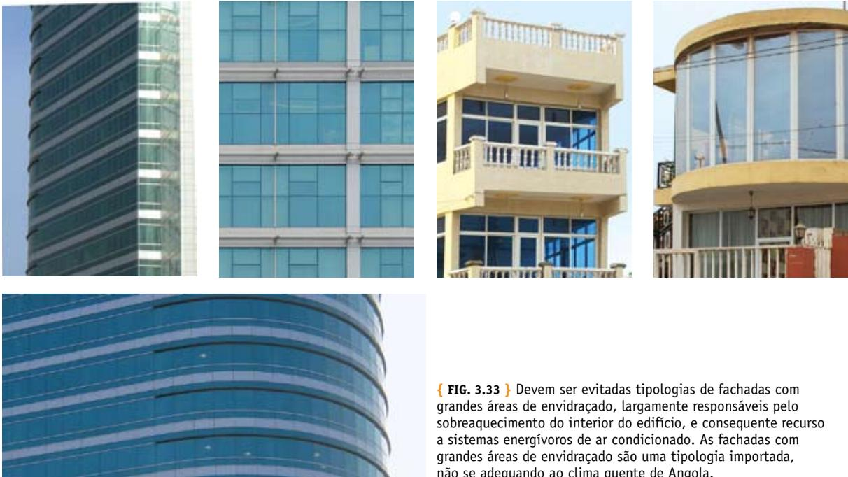
{ FIG. 3.33 } Devem ser evitadas tipologias de fachadas com grandes áreas de envidraçado, largamente responsáveis pelo sobreaquecimento do interior do edifício, e consequente recurso a sistemas energívoros de ar condicionado. As fachadas com grandes áreas de envidraçado são uma tipologia importada, não se adequando ao clima quente de Angola.
