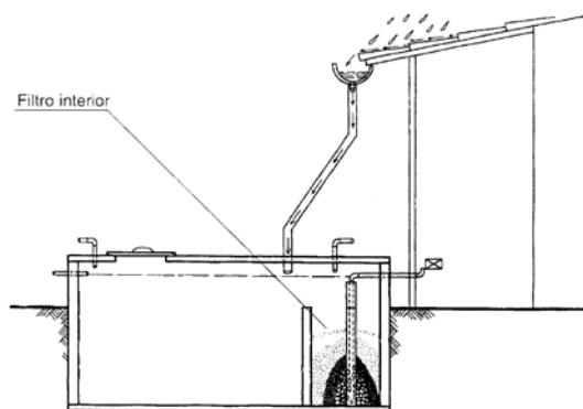
{ FIG. 4.5 } Sistema de filtração da água da chuva.
