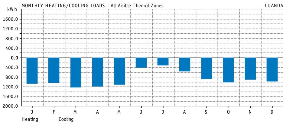
{ FIG. A1.26 } Consumo energético estimado para climatização. Observa-se que o consumo se deve exclusivamente ao arrefecimento, não havendo necessidade de arrefecimento. Nesta simulação consideraram-se limites de conforto entre 18°C e 26°C, i.e. o sistema de climatização entra em funcionamento quando o limite de 26°C é atingido. O valor do consumo anual é de aproximadamente 228 KWh/m<sup>2</sup>.
