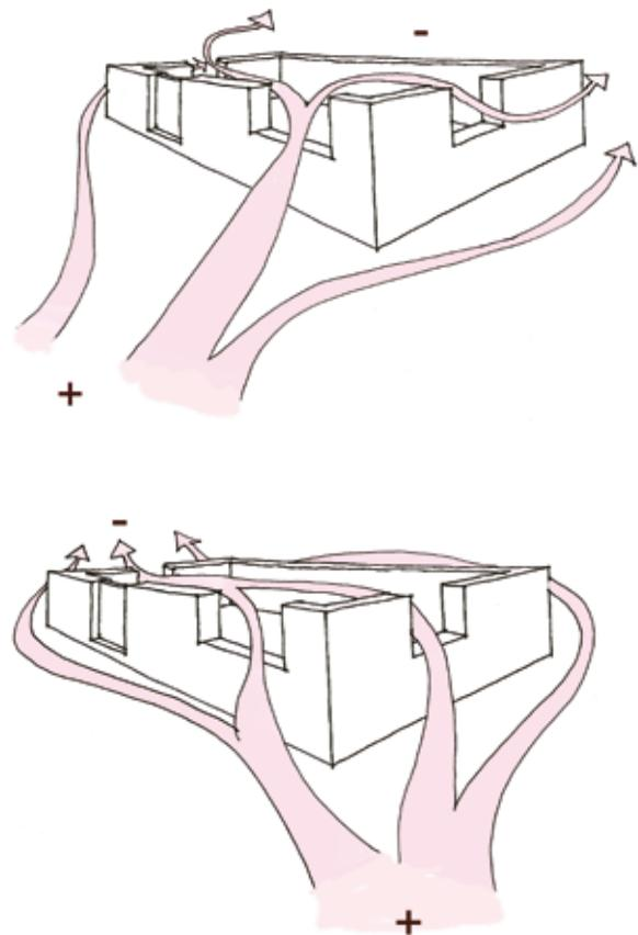
**{ FIG. 3.39 }** As pressões positivas e negativas causadas por diferentes direcções do vento e as posições das aberturas.
