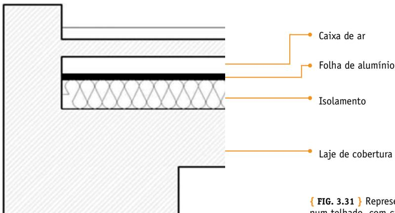
{ FIG. 3.31 } Representação esquemática de uma barreira radiante num telhado, com caixa de ar ventilada.
