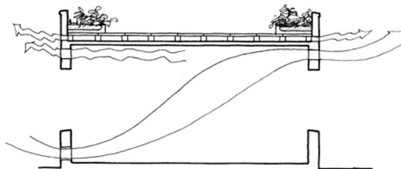
**{ FIG. 3.54 }** Esquema de um edifício ventilado pela cobertura. A maior parte dos ganhos e perdas térmicas dá-se através da cobertura, por estar mais exposta à insolação.
