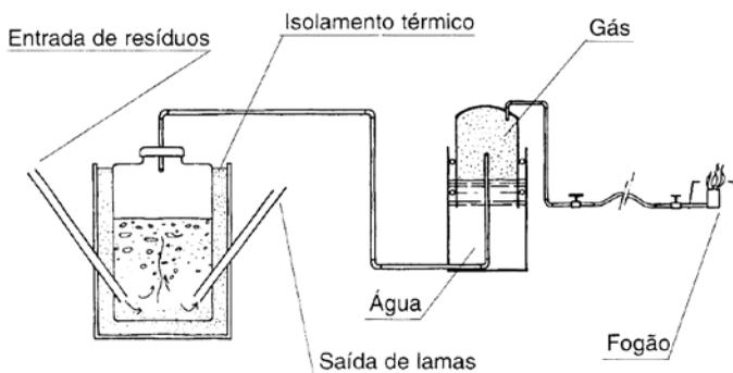
{ FIG. 5.7 } Elementos para a auto-construção de pequenas unidades de produção de biogás.
