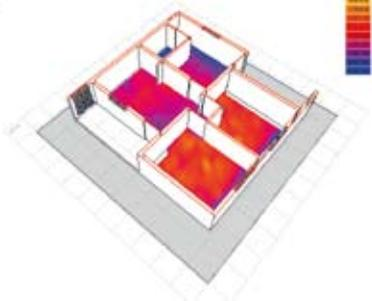
{ FIG. A1.24 } (à esquerda) Análises de Iluminação Natural: situação inicial. Factor luz e iluminâncias para um dia frio (15 de Julho). Os valores do Factor Luz do Dia encontram-se, em média, entre 2 e 4%, correspondendo a uma variação entre 150 e 800 Lux. Os valores são aceitáveis, dentro dos limites recomendados, e a distribuição de luz no espaço é relativamente uniforme.
