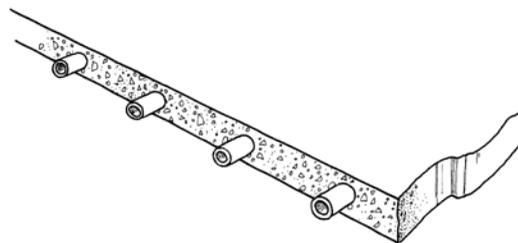
**{ FIG. 3.53 }** Pormenor de um piso ventilado com tubos PVC. As lajes podem ter canais de circulação de ar para climatização da habitação. Estes canais devem ter entrada e saída para o exterior para que o ar circule e se renove no interior do piso. As aberturas devem ser protegidas contra a entrada de insectos.
