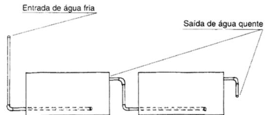
{ FIG. 5.2 } Depósito de água isolado e ligação de vários depósitos.
